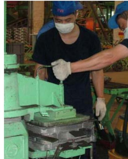
鋳物工場は、整理整頓が十分にされていて、鋳込や成型もフル回転操業のようでした。モールドイングマシンは、1人1台ではなく、常時2人が付いていた。1人が型を込め終わると、次の者が型込めを始める。非常に効率よく考えられたシステムであると感じた。切削加工場でも、不良品が発見されると、その場で不良品をピックアップし、以後ラインには流さない基本的な考え方が浸透されていた。
